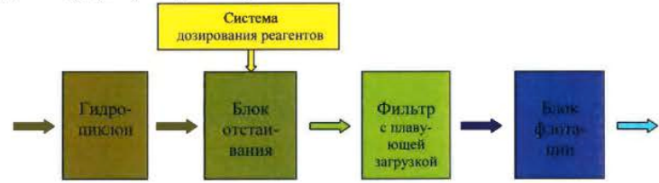
Рисунок 8 – Принципиальная технологическая схема установки серии «МОЙДОДЫР-М(ДР)»
