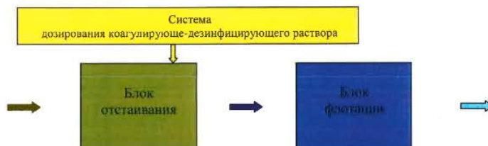
Рисунок 10 – Принципиальная технологическая схема установки серии «МОЙДОДЫР-М(КФ)»
